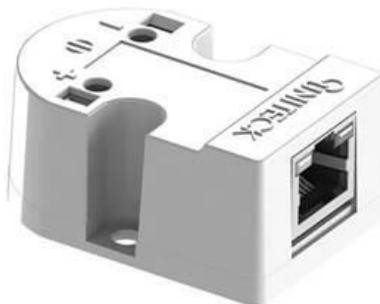
UNISENSOR permite también optimizar la medición de voltaje para una más de precisión durante la carga. Gracias, al UNISENSOR, la medición de voltaje ya no lo hace a través del regulador, sino directamente en la batería para evitar caídas de voltaje causadas por el cableado. Con el fin de medir y controlar la carga con mayor precisión.
