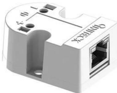
UNISENSOR permet aussi d'optimiser la mesure tension pour plus de précision durant la charge. Grâce à l'UNISENSOR, la mesure de tension se fait non plus aux bornes du régulateur, mais directement aux bornes de la batterie évitant ainsi les pertes en ligne dans les câbles de puissance et donc une mesure et une régulation plus précise de la charge.
